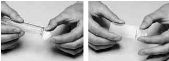
Afbeelding 4.1: sediment op dekglasje brengen en op voorwerpglasje leggen
